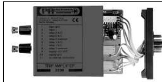
Billede 3: Udtagelse af print for dipning og flytning af jumpere.
